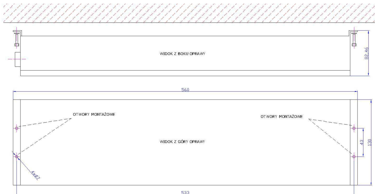
Rys. 1. Rysunek montażowy oprawy oświetleniowej
