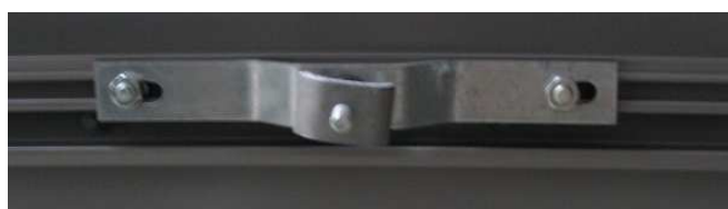
Fot. 4.10. Widok uchwyty zamontowanego na profilu aluminiowym tablicowym
