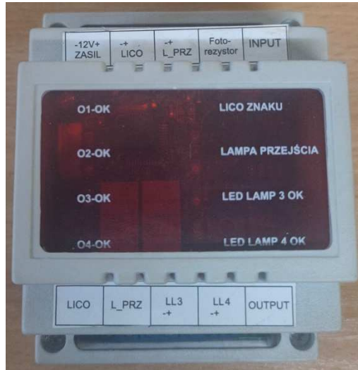
Fot. 4. Widok sterownika SULED1
